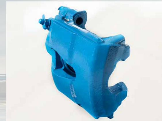
Das Ergebnis des 1K-Sprühlackes kann sich sehen lassen. Die Farbkraft ist super, die Farbschicht nur bedingt robust
